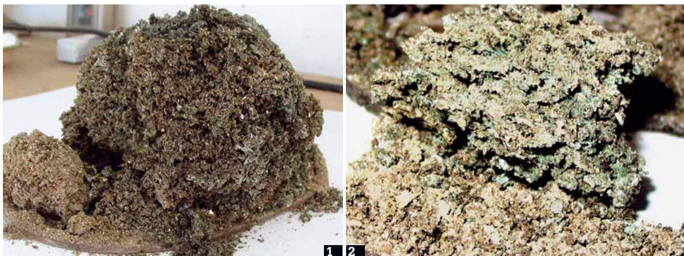
Foto 1 e 2 Scorie di fusione da combustione incompleta di pellet di vite in una caldaia a pellet con focolare a tazza
