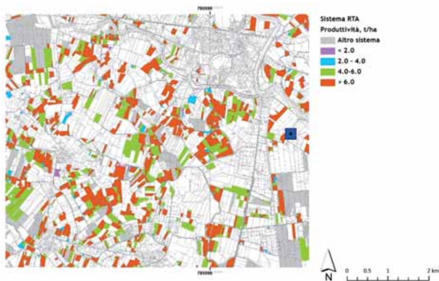
Figura 4. Distribuzione delle superfici a vigneto tecnicamente adatte al sistema di raccolta con rotoimballatrice e relative produttività del sistema in relazione alla geometria delle superfici e densità dei sarmenti
